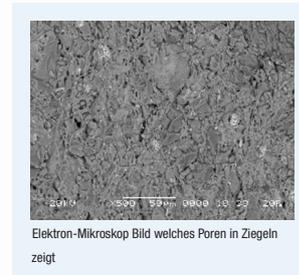
Elektron-Mikroskop Bild welches Poren in Ziegeln zeigt
