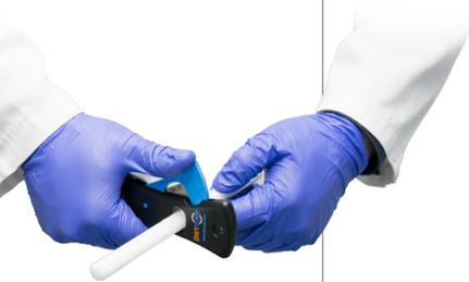
Dryrods können mit dem Dryrod CutterI zugeschnitten werden.
