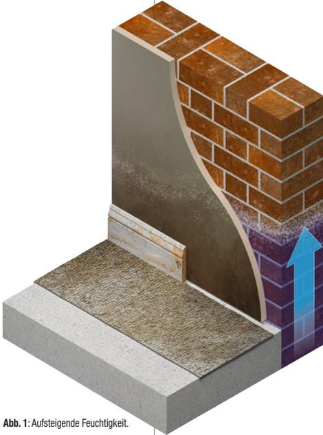
Abb. 1: Aufsteigende Feuchtigkeit.
